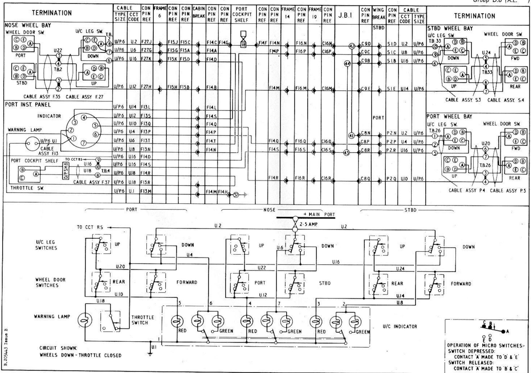
**FIG. 1. ALIGHTING GEAR INDICATOR**
